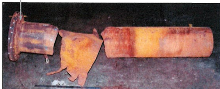
รูปภาพที่ 7 การแตกของท่อ VCM (รูปภาพจากสมาคมการสึกหรอและการหล่อลื่นไทย)
